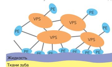
Новая химическая формула позволила избежать дифузии гидрофильтных компонентов, которые полностью интегрированы
